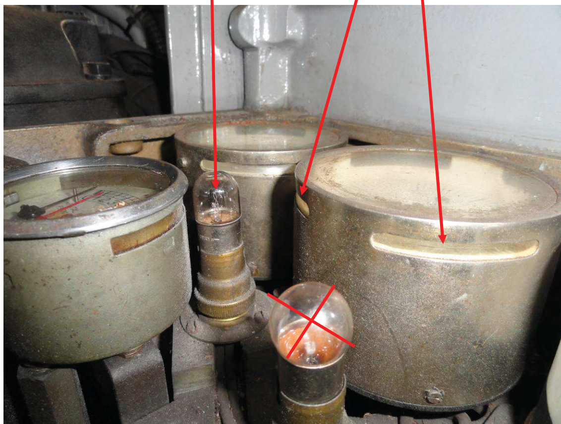
Figura 9.2 - Sistema di retroilluminazione della strumentazione
