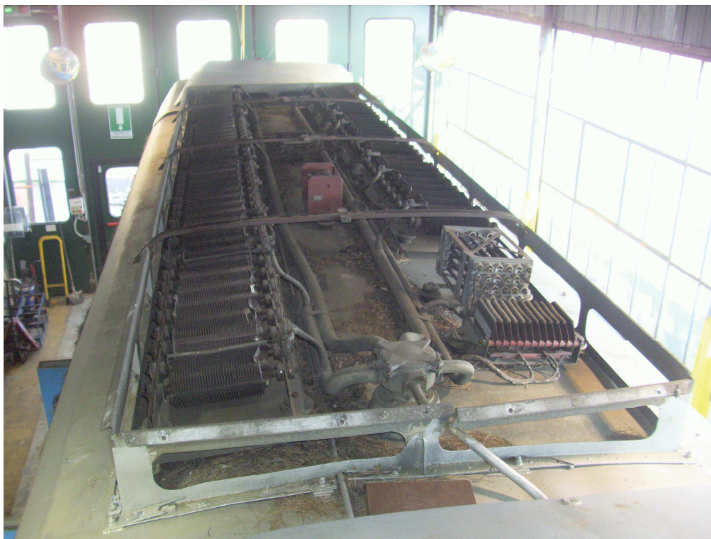
Figura 16.1 - Reostato esistente vista da lato Genova
