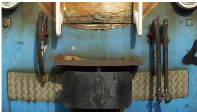
Figura 6-12 – Connessioni flessibili di testata
