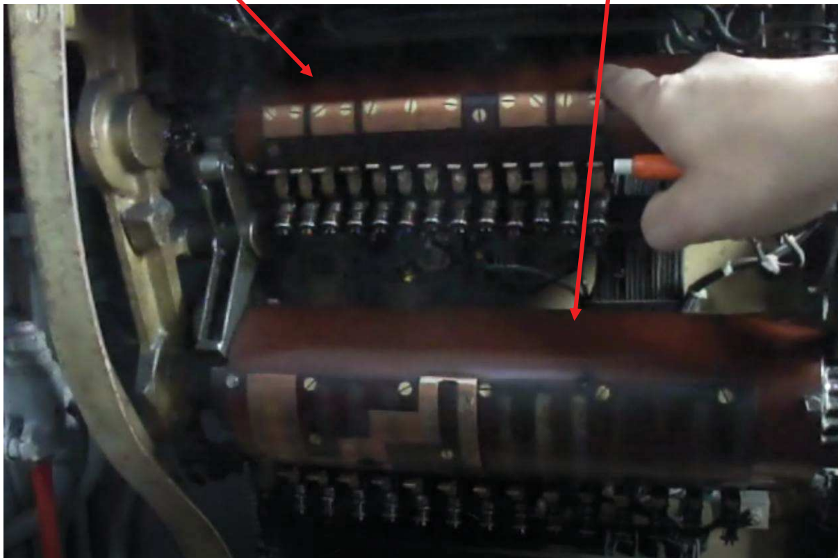
Figura 5.1 - Tamburi di commutazione trazione e direzione
