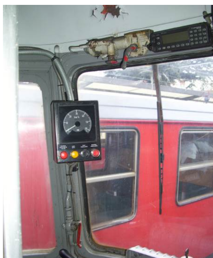
Figura 6-5 – In alto, alimentazione pneumatica del tergicristallo da non ripristinare. In basso a sinistra, leva di comando del fischio da spostare secondo disegno in Rif. [10]
