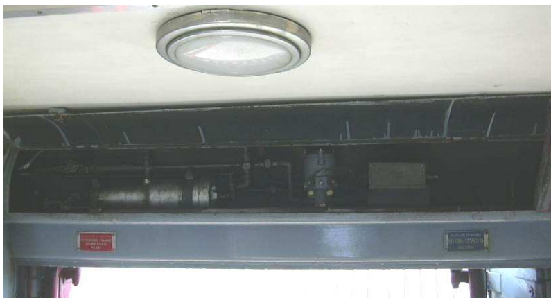
Figura 6-17 – Equipaggiamento pneumatico per apertura porte di salita
