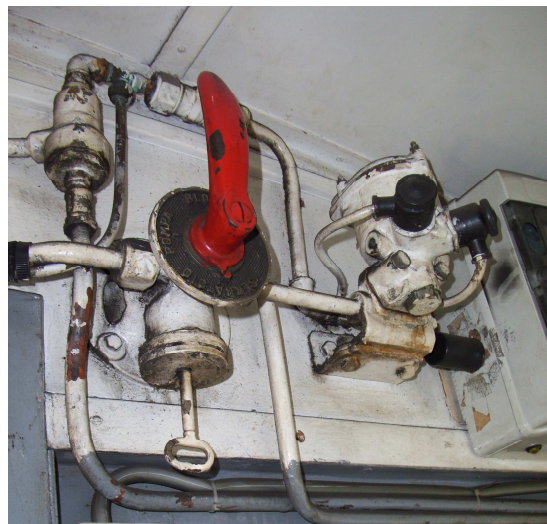
Figura 6-7 – A sinistra: serbatoio e pompa manuale per alzamento pantografo in cab. Genova. A destra: dispositivo di blocco ed elettrovalvola di comando presa di corrente
