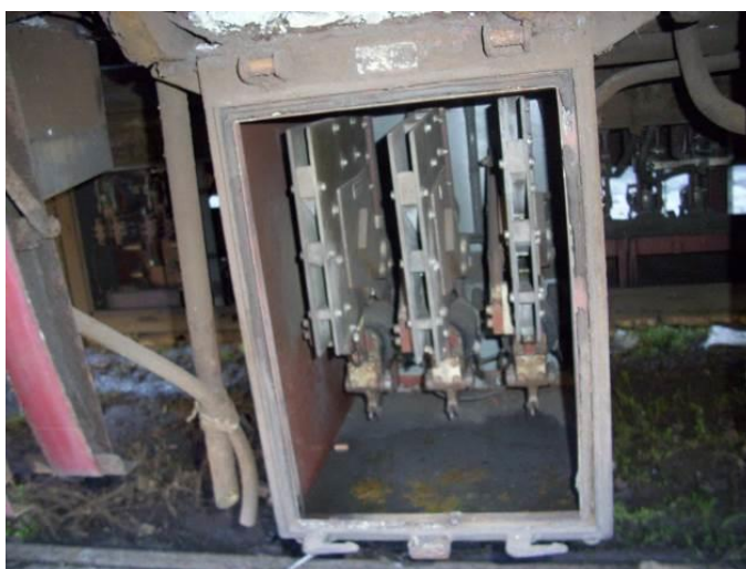
Figura 5-6 – Cassa contattori ausiliari
