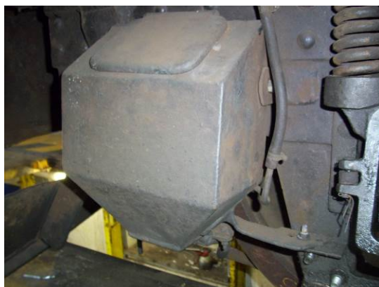
Figura 6-13 – Connessione flessibile per le sabbie
