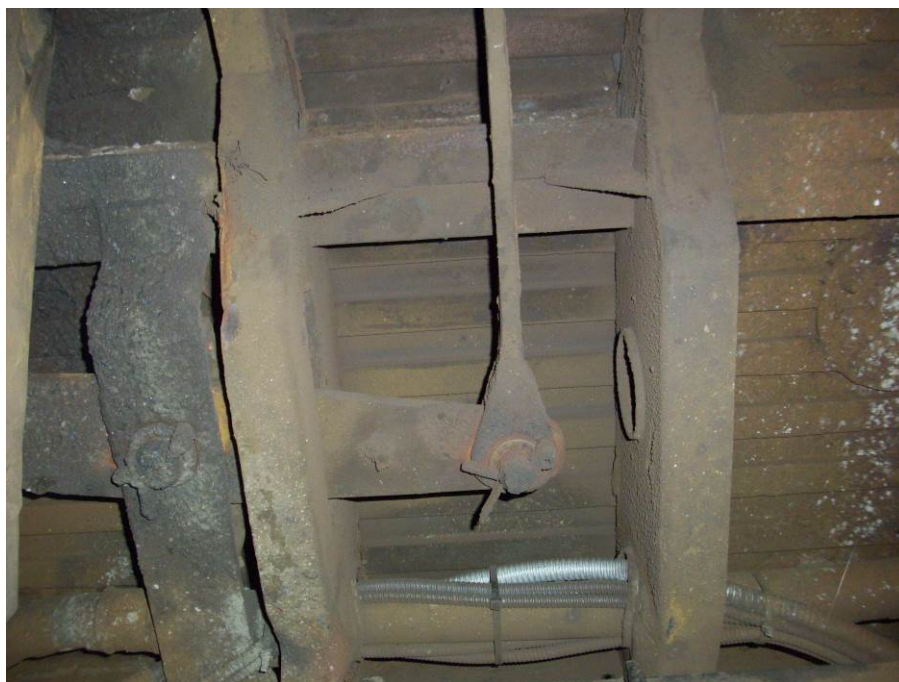
Figura 6-16 – Porzione della timoneria dell'impianto frenante
