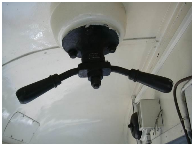
Figura 9-5 – Maniglia sezionatore pantografo
