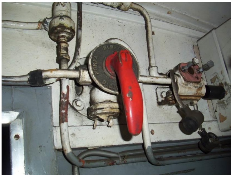
Figura 9-2 – Apparecchiature pneumatiche di sicurezza impianto AT
