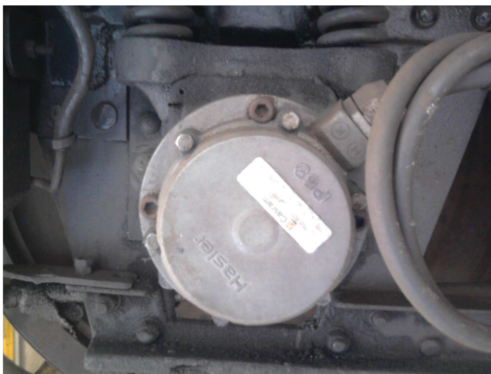
Figura 24 – Applicazione tachigrafo generatore di impulsi sulla boccola
