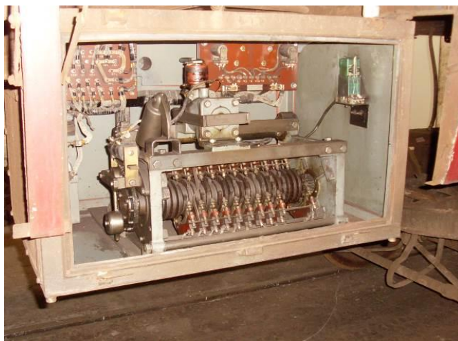
Figura 5-5 – Cassa combinatore automatico
