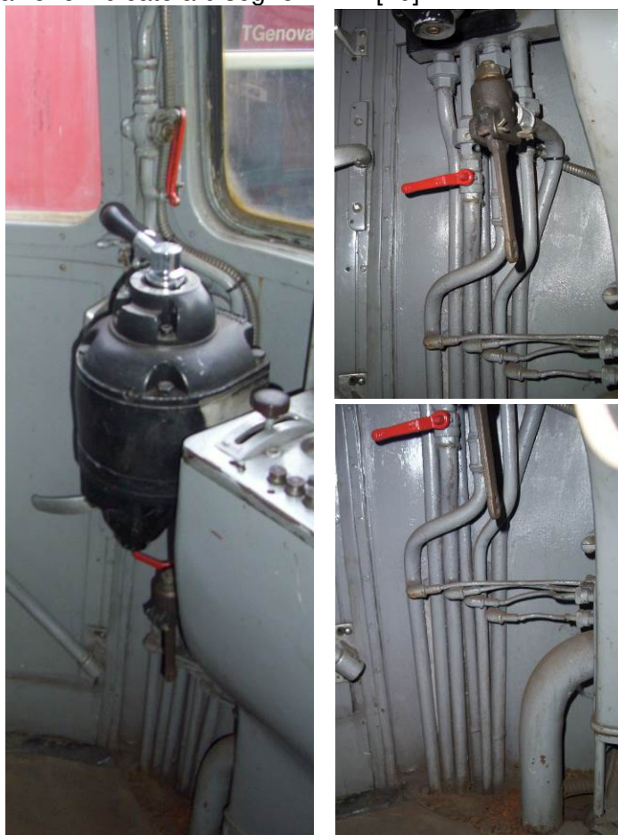
Figura 6-4 – A sinistra il rubinetto di comando con manubrio asportabile. A destra i tubi di connessione al rubinetto e ai manometri.
