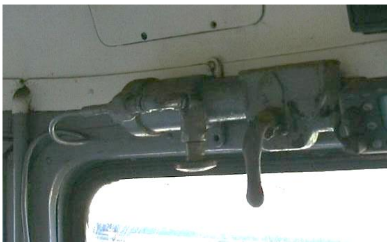
Figura 9-8 – Tergicristallo pneumatico
