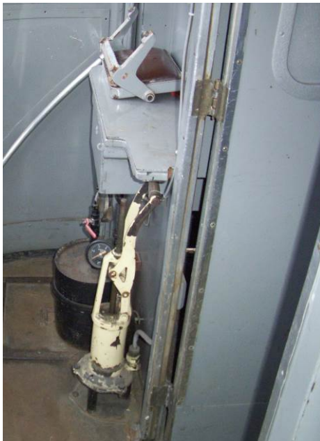
Figura 6-7 – A sinistra: serbatoio e pompa manuale per alzamento pantografo in cab. Genova. A destra: dispositivo di blocco ed elettrovalvola di comando presa di corrente
