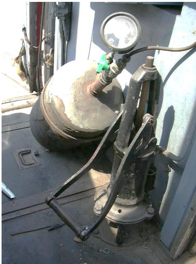
Figura 9-7 – Meccanismo alzata pantografo
