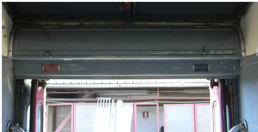
Figura 11-1 – Cassonetto porte contenente il meccanismo di apertura
