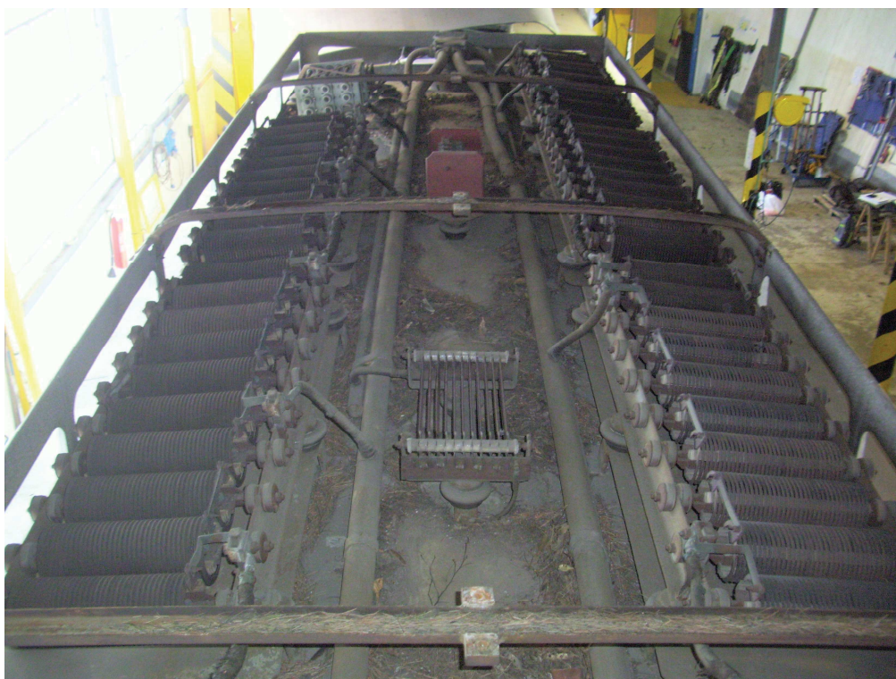
Figura 16.2 - Reostato esistente vista da lato Casella
